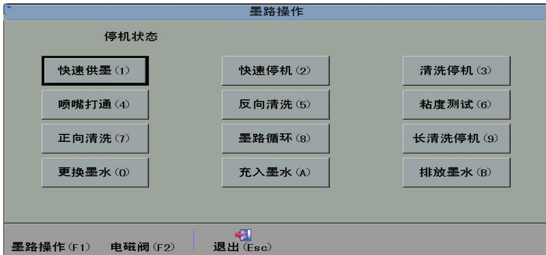
进入墨路操作界面后会提示当前机器的工作状态，如上图提示：停机状态。有些墨路操作在特定状态下才可以操作，不可以操作的选项会以灰色字体呈现，此时键盘操作无效。
