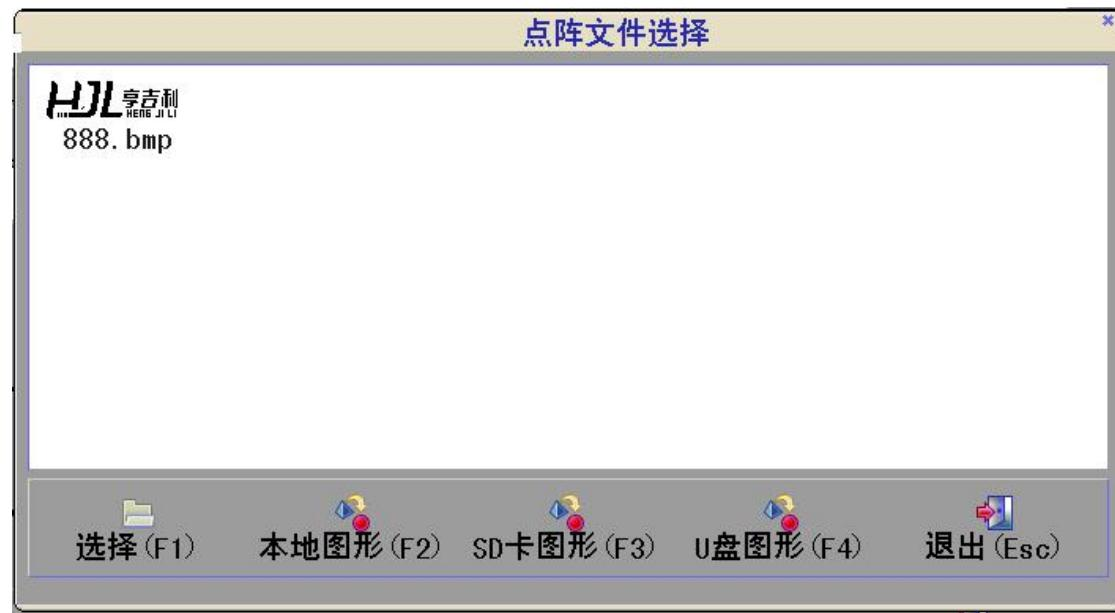
按本地图形 (F2)，空白处只显示本地图形文件，其他位置的图形文件不显示，如本地图形没显示任何东西，说明本地没有 BMP 图像文件，或者里面的文件格式及内容不符合本设备。按方向键来选择文件，确定好文件后，按选择 (F1) 打开该文件并进入图形编辑界面对图标文件进行编辑。按 SD 卡图形 (F3) 和 U 盘图形 (F4)，出现的结果一样，处理方式也一样。如无需打开任何图形文件，按退出 (Esc)，返回图形编辑界面。
