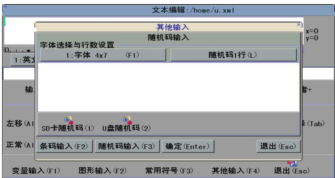
随机码数据源的格式必须是后缀为.txt 文档，而且每行的数据的位数都必须相同，如果不同，必须以位数最大的位数为基础，不足的位数以空格补齐。随机码的文档可以储存在 SD 卡或者 U 盘，所以在读取随机码时，请先选择储存媒介，按 SD 卡随机码（1），从 SD 卡读取随机码，按 U 盘随机码（2），从 U 盘读取随机码。读取的随机码数据信息在空白处显示，以方向键来选择。对随机码的字体的选择可以预先设置好，按字体 4x7（F1）来选择。
